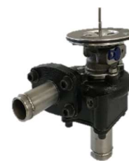
Figura 3. Vista isométrica de las partes a utilizar del turbocompresor K16, junto con sus bridas para su acoplamiento al prototipo de planta OTEC-CC-MX-1kWe. Fuente: Elaboración propia.
